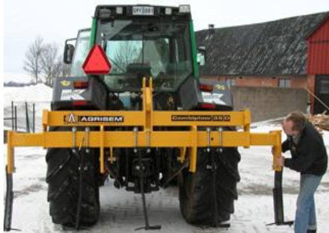
Den i Sverige anvendte maskintype. Der bruges maskiner med 2-5 tænder, med forskellig slags stenudløsning eller som denne uden. Foto: Lyckeby
