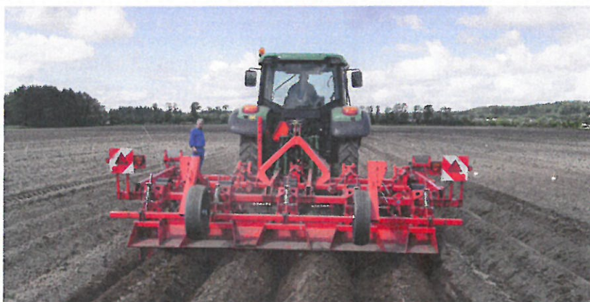
Øko-plovhypper er en tung maskine, som trykker jorden og det er formentlig årsag til udbyttereduktion. Laver en stor og flot kam, som kan være en fordel i spisekartofler.
