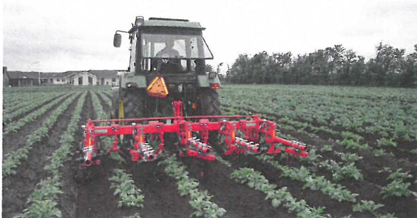
Stjernerullerenser er den mest effektive overfor rodukruddet, men kan lave stor skade på rødderne ved anden rensning.
