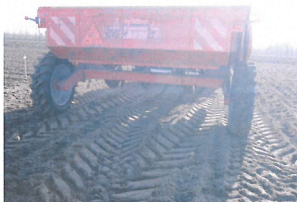
Foto 3: Jordløsner til montering mellem traktor og lægger
