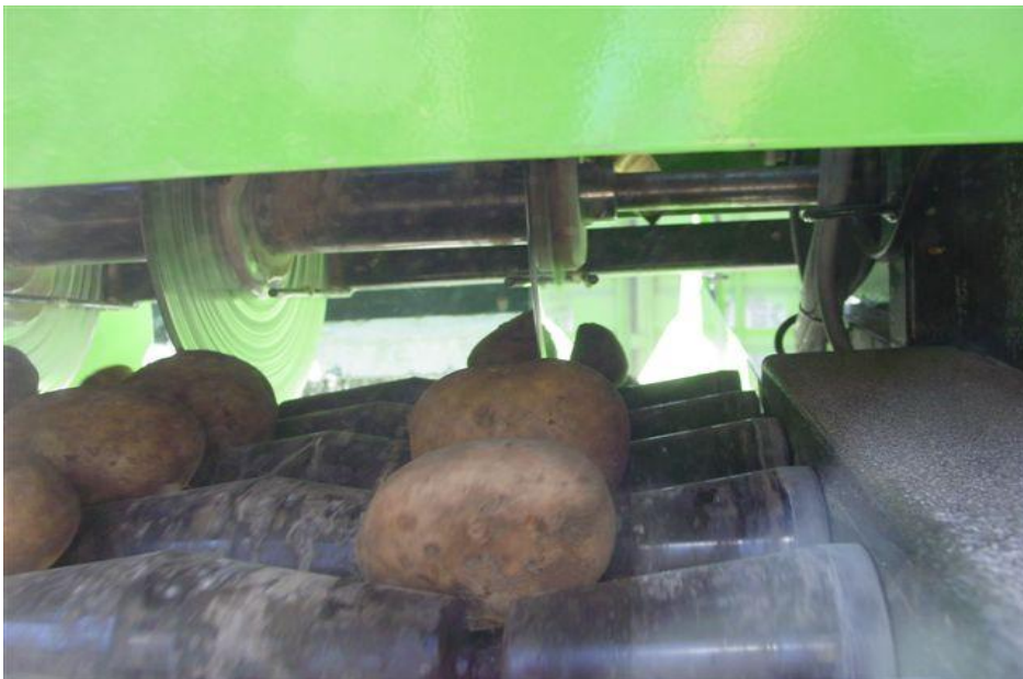
Læggekartoflerne lines op vha. koniske ruller og ledes til den roterende overskæringskniv, der løbende desinficeres.
